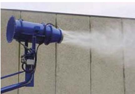
Pour le traitement des zones de passage ou de travail nous sommes en mesure de fournir des canons de brumisation avec une portée qui peut arriver jusqu'à 50 mètres et qui sont équipés avec un système de pivotement automatisé ou télécommandé.
