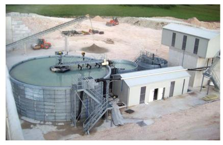
L'impianto di chiarificazione ha la funzione di recuperare le acque torbide provenienti dal lavaggio di inerti per poterle riutilizzare nel processo produttivo. Il principio di funzionamento del nostro sistema si basa sulla chiarificazione per sedimentazione delle torbide entro una vasca denominata chiarificatore; il processo è velocizzato da sostanze flocculanti
